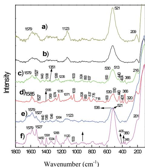
Figure 3: SERS of diclofenac (in methanol) on Ag colloid (pH=12): a)  $10^{-3}$  M+Na<sub>2</sub>SO<sub>4</sub>  $10^{-2}$  M (X2); b)  $10^{-6}$  M+Na<sub>2</sub>SO<sub>4</sub>  $10^{-2}$  M; c)  $10^{-4}$  M+KNO<sub>3</sub>  $10^{-2}$  M; d)  $10^{-3}$  M+KNO<sub>3</sub>  $10^{-2}$  M; e)  $10^{-5}$  M+KNO<sub>3</sub>  $10^{-2}$  M (X4); f)  $10^{-6}$  M+KNO<sub>3</sub>  $10^{-2}$  M (X3).
